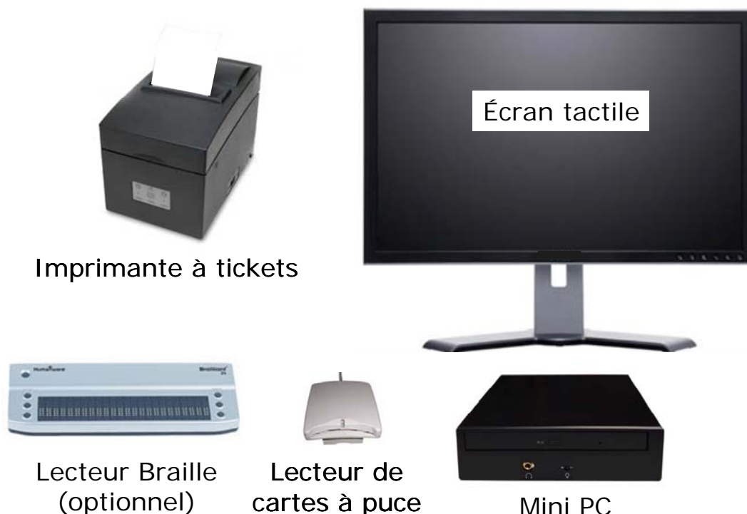
Figure 7: Equipement présent dans l'isoloir (bulletins à code à barres)
