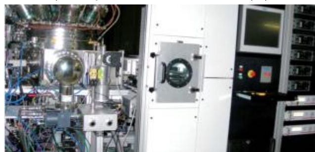
Sistema de pulverização catódica confocal com 11 alvos pequenos
