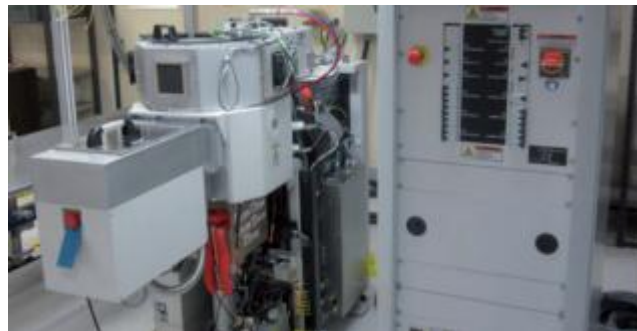
Sistemas de remoção de metais e óxidos por plasmas reactivos
