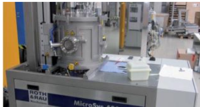
Sistema de deposição p/ fabricação de nanotubos de carbono e grafeno
