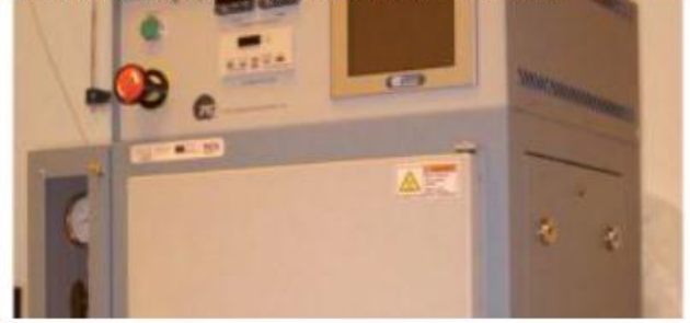
Forno para aplicação de HDMS em camadas fotosensíveis
