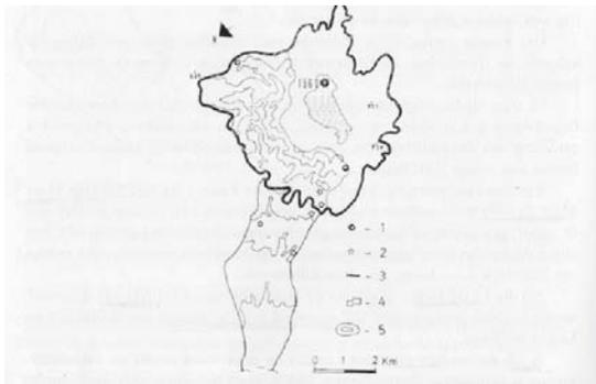
Fig. 8 - A Reserva Natural da Lagoa do Fogo e a respectiva bacia hidrográfica da Ribeira Grande: 1-Posto udométrico; 2-nascente; 3-limite da Reserva Natural; 4-furo geotérmico; 5-curvas de nível.
