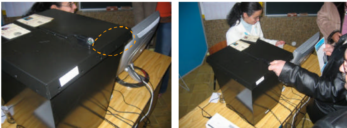
Figura 7 - Pormenor de urna electrónica usada em Santa Iria de Azóia (apenas é visível o leitor de i-buttons colocado sobre uma urna tradicional, e não o computador a que o leitor está ligado).
