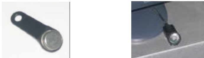
Figura 9 - Pormenor de um "i-button" (esquerda) e de um leitor/gravador de i-buttons (direita).
