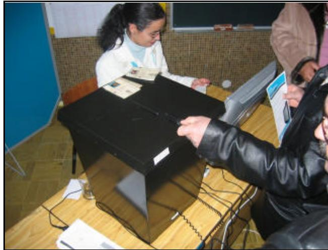
Figura 21 – Urna electrónica com leitor de *i-buttons* (não se vê o computador a que o mesmo está ligado).
