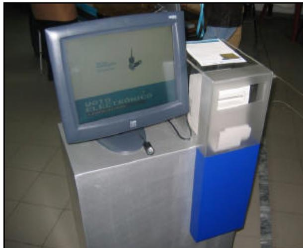
Figura 20 – Cabina de voto com dispositivo de leitura e escrita para o *i-button* e uma impressora protegida à sua direita.
