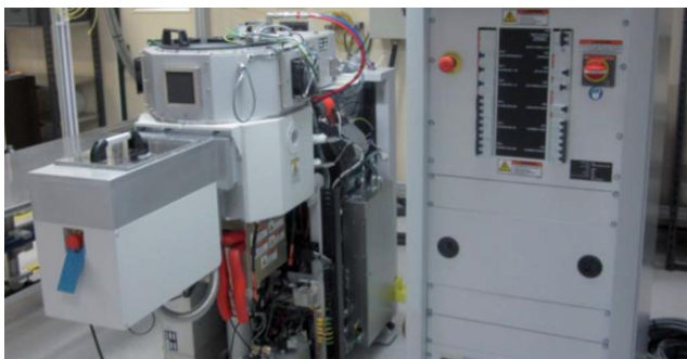
Sistema de pulverização catódica confocal com 11 alvos pequenos
