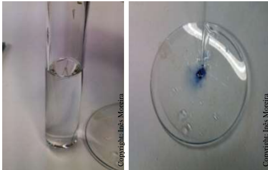
Figura 12: Teste de flutuação e teste de difenilamina
