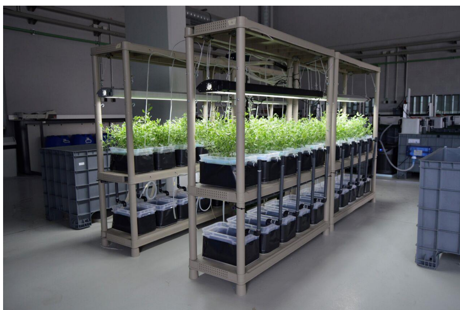
Figura 5: Sistema experimental de produção de plantas halófitas (ECOMARE, Universidade de Aveiro) onde estas plantas tolerantes ao sal são produzidas sem solo em regime de hidroponia para modulação da sua plasticidade fenotípica. Foto por Marco Custódio (CESAM, Universidade de Aveiro).
